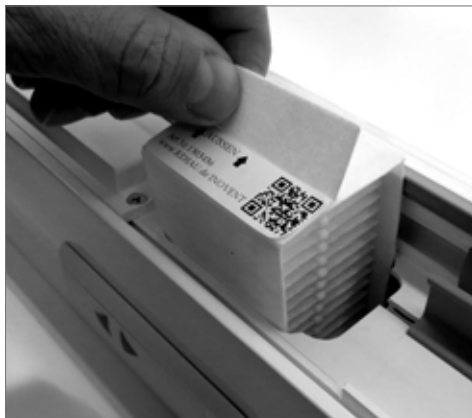
Herausziehen der alten Filterkassette
