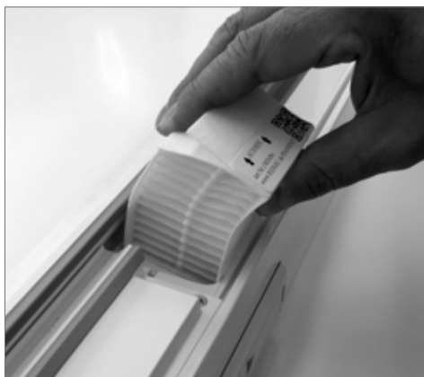
Einsetzen der neuen Filterkassette
