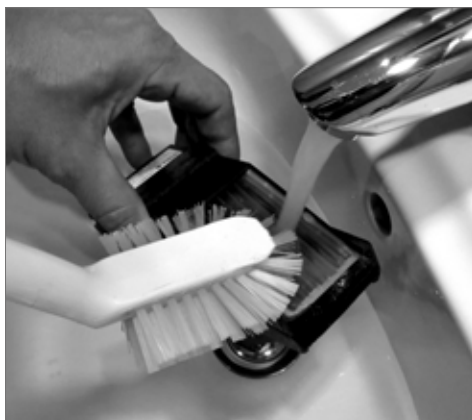
Reinigen des Wärmetauschers
